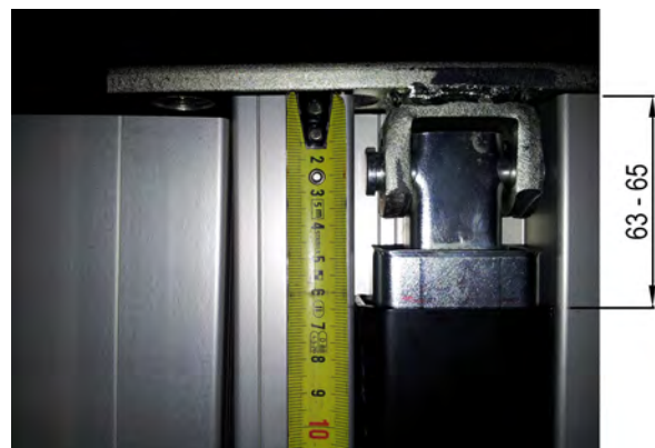
Montáž zvedacího sloupku DG do Al rohového sloupku
